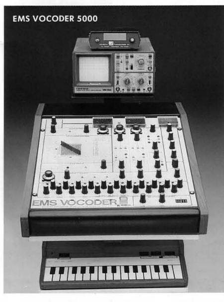
Der VOCODER 5000 ist das größte Modell der EMS VOCODER Reihe. Seine 22 Filterwege werden über eine **Kreuzschiene** variabel gesteckt. Zusätzliche Modulkarten machen aus diesem VOCODER ein komplettes **Experimental-System**.
