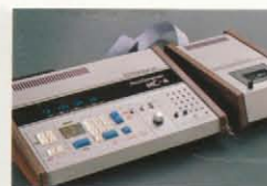
●写真は、MC-4BタイプとMTR-100を接続コネクターでつないでいます。
